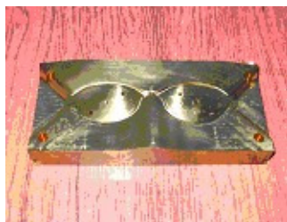
Fig.5. Element activ de matriță pentru injecția ramelor de ochelari realizat în cadrul laboratorului de Fabricație Asistată de Calculator
