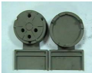
Fig.7. Elemente active de matriță fabricate prin SLS
