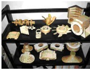
Fig.6. Piese LOM fabricate în cadrul laboratorului de FRP
